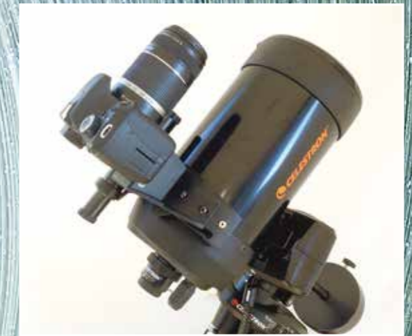
Cámara en paralelo.
